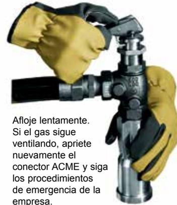
Afloje lentamente. Si el gas sigue ventilando, apriete nuevamente el conector ACME y siga los procedimientos de emergencia de la empresa.
